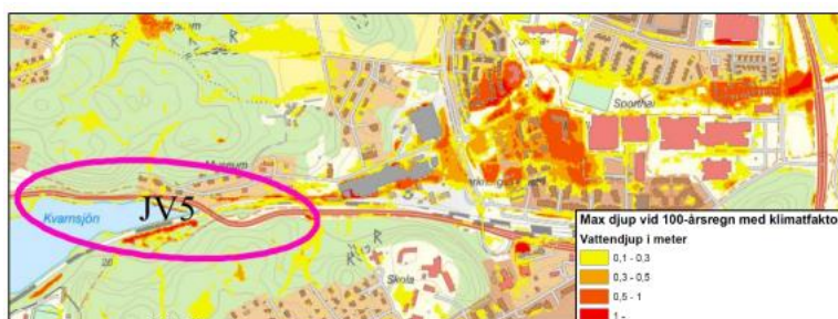
Figur. Område vid Kvarnsjöns utlopp där järnvägen riskerar att översvämmas, se markering JV5
