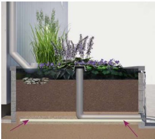
Figur 16: Nedsänkt respektive upphöjd regnbädd med översvämningskydd, bräddavlopp och dränering.
