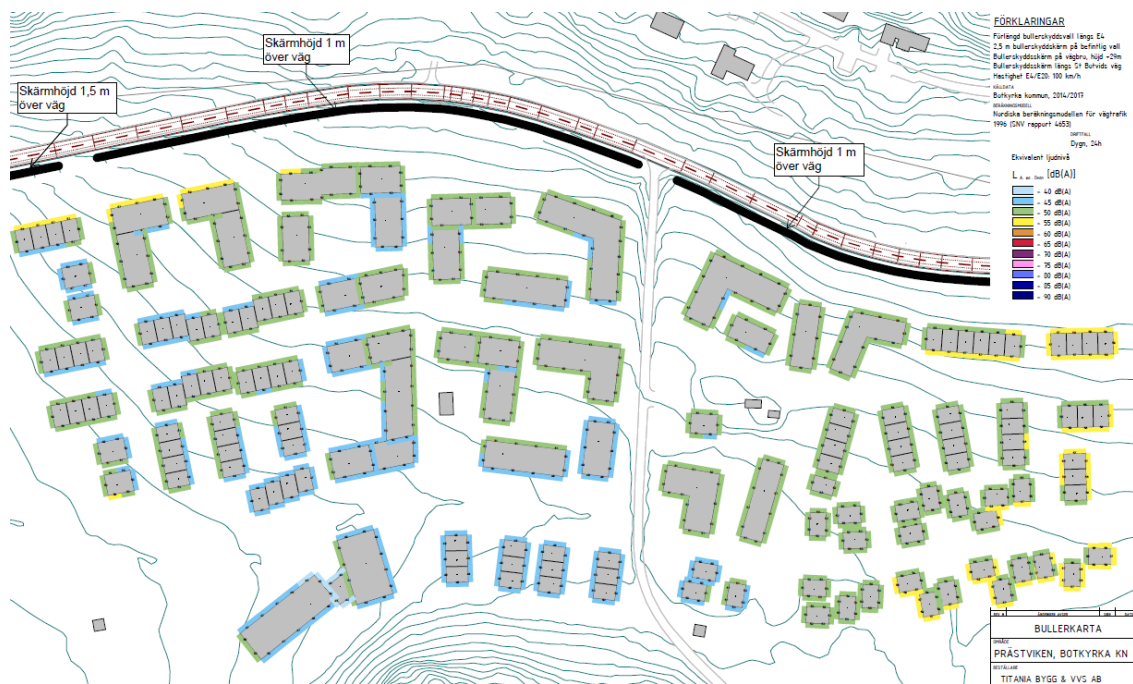
Figur 15. Bullerkarta högsta ekvivalent nivå dBA vid fasad. Gröna och blå fasader exponeras för nivåer under 55 dBA. Gula fasader exponeras för nivåer över 55 dBA. Utsnitt från Trafikbullerutredning Prästviken-Eriksberg.
