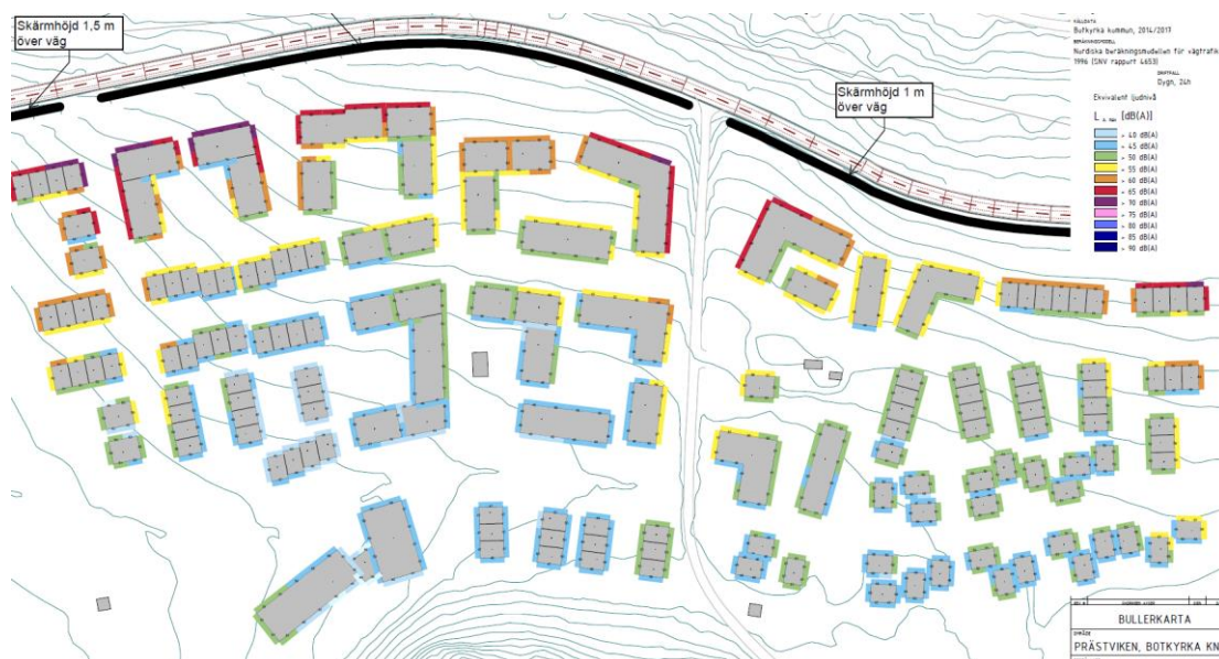
Figur 16. Bullerkarta högsta maximal nivå dBA vid fasad. Gröna och blå fasader exponeras för nivåer under 55 dBA. Gula fasader exponeras för nivåer över 55 dBA. Orangea fasader exponeras för nivåer över 60 dBA, röda över 65 dBA och lila över 70 dBA. Utsnitt från Trafikbullerutredning Prästviken-Eriksberg.
