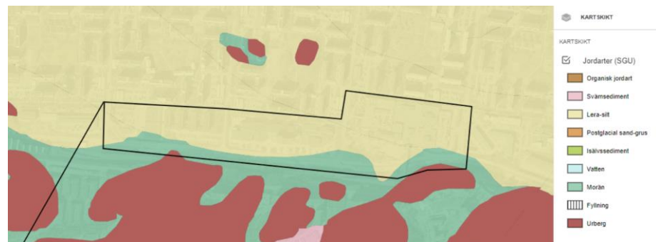
Fig.3. Marken i området består huvudsakligen av morän (grusås) och lera-silt.
